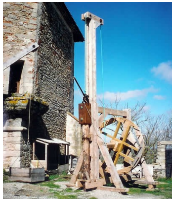
Machine Médiévale (Enfonce pieux).
